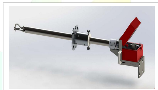
Слика бр. 5 и 6: Инструмент Dado Lab Isokinetic Sampler ST5 EVO и HP5 грејна сонда со грејно куќиште за филтер, S питот сонда и сензор за температура
