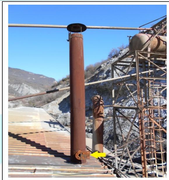
Слика бр. 3 : Испуст од печка со мерно место
